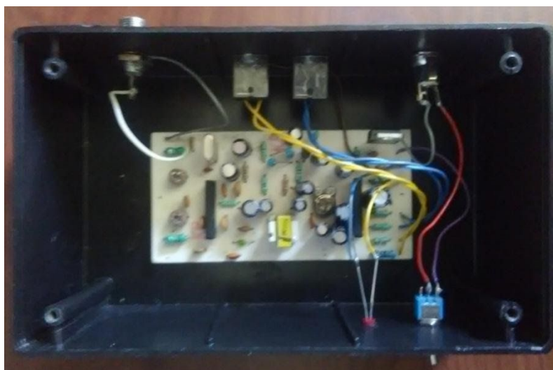
Figura 4.9: Receptor de 19.9 MHz, elaborado por Daniel A. Rossano.
